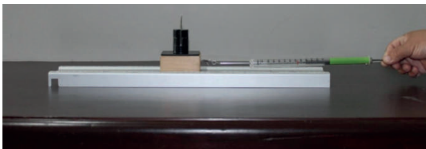
Figura 30. Medición de la fuerza de fricción estática entre el bloque con masa de 0.25 kg y la pista de aluminio. Obsérvese la medida que indica el dinamómetro
