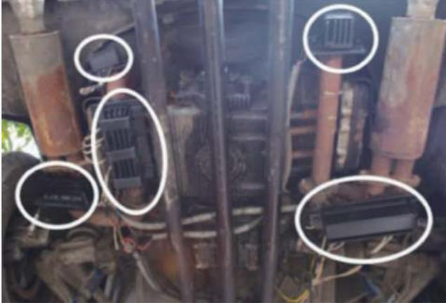
**Figura 10.10.** Vista inferior del vehículo con el sistema ATEG
